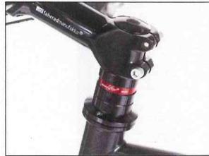
Der Gabelschaft im klassisch-eingepressten Steuersatz ist für den Einbau eines Speedlifter präpariert.
