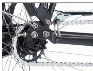
Das geteilte Slider-Ausfallende macht den Rahmen teurer. Ein Kettenantrieb deckelt die Kosten.
