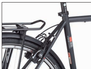
Der Träger ist mit einer 3D-Lasche steif am Rahmen angebunden.
